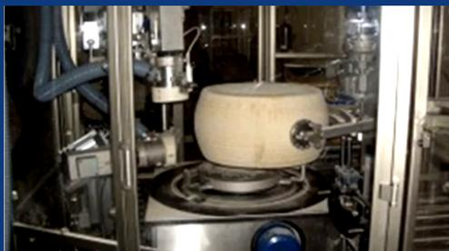
Macchina automatica per la pulizia semplice e approfondita dei formaggi. Ideata per la pulizia della crosta, con un livello di profondità regolabile in base al risultato che si desidera ottenere.
